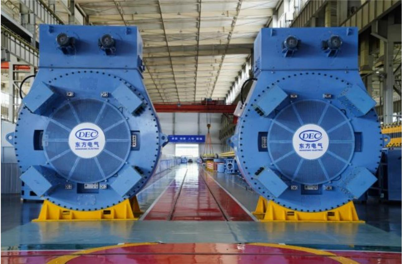
26兆瓦级海上风电机组采用第三代全集成半直驱技术路线，轴系、齿轮箱和发电机高度集成，具备纯扭矩、高承载、高可靠等特点。其中发电机与已并网的18兆瓦海上半直驱风电电机相比，扭矩增加67%、风电电机振动值降低36.8%、温升降低5.9%。
