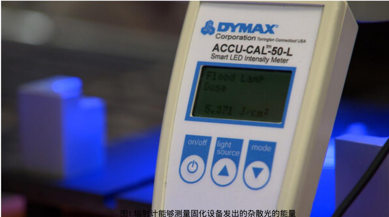
图1.辐射计能够测量固化设备发出的杂散光的能量
