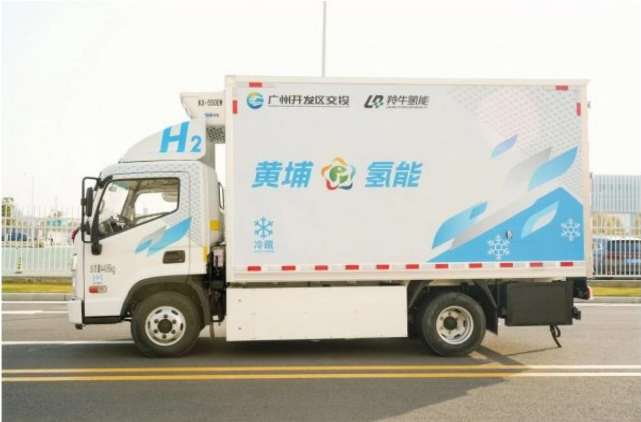
本批190台氢燃料电池冷藏车由HTWO广州与现代氢能科技H2 Solution共同研发，整车及核心零部件的研发与生产过程深度融合了“黄埔制造”的创新理念与先进工艺。底盘系统由现代商用车工厂倾力打造，配备国内领先的动力配置，电机峰值功率140kW，峰值扭矩达到了360N·m，氢电转换效率居国际一流水平，在显著提升能源利用效率的同时，有效降低了车辆运行能耗与碳排放，具备卓越的加速性能、强大的爬坡能力以及长续航里程等显著优势。作为广东省重点外资引进项目，HTWO广州不仅充分汲取现代汽车集团长达27年的深厚氢能研发技术积淀与领先科技成果，更积极携手当地优质企业，大力推进核心零部件的本地化生产进程，以实际行动切实贯彻“在中国，为全球”的战略方针与发展理念，为区域经济发展与产业升级贡献力量。
