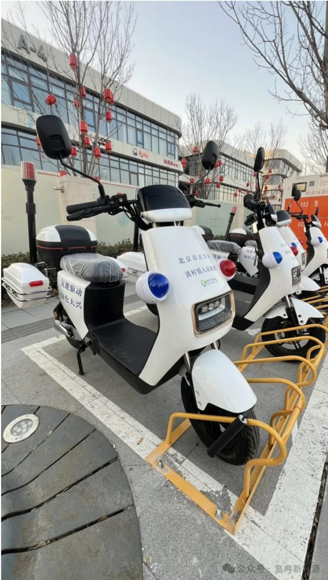
氢冉氢能电动巡逻车曾获2023年北京市新技术新产品认证。本批氢能电动巡逻车辆搭载氢冉新能源自主设计开发的50g固态储氢装置及400W小型风冷燃料电池系统，双瓶可实现车辆100KM续航里程。氢冉新能源并通过固态换氢柜为客户提供连续氢能供应。
