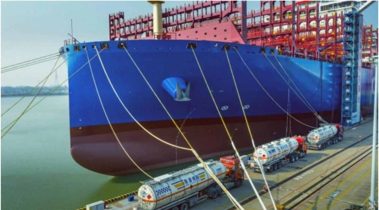
2024年12月26日，扬州中远海运重工承建的首制16000TEU甲醇双燃料集装箱船(N1071)成功加注甲醇燃料，这标志着国内首次为大型双燃料集装箱船加注甲醇的重要里程碑。此次加注作业由中国船燃江苏公司实施，展现了中远海运集团在甲醇新能源产业链建设方面取得的实质性进展。
