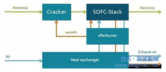
使用氢气发电不会产生任何破坏气候的排放。但储存和运输氢气带来了技术挑战。考虑到这一点,弗劳恩霍夫(Fraunhofer)的研究人员使用氨作为起始材料,氨是一种更容易处理的氢衍生物。氨在高温燃料电池堆中裂解,在此过程中产生的氢转化为电能,过程的废热也可以加以利用。
